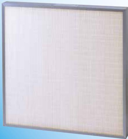
フィロプリーツVM型は、ろ材を細かく折り込むことにより、低圧力損失化を実現した奥行き65mmの薄型、軽量タイプの中高性能フィルタです。また、使用後は当社「使用済フィルタリサイクルシステム」で処理できます。
